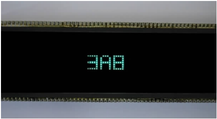
图 4 三极 FED 的典型发光图像
